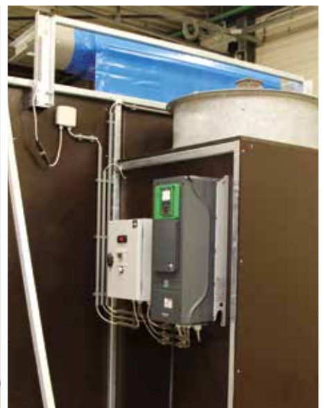
AB Speedbox: links het vooraanzicht met bovenaan het zeil dat je over de paletten heen moet trekken. Rechts de achterzijde met het schakelbord met frequentieregeling en het temperatuurdisplay om de gewenste temperatuur in te stellen. Bovenaan zie je de krachtige ventilator.
